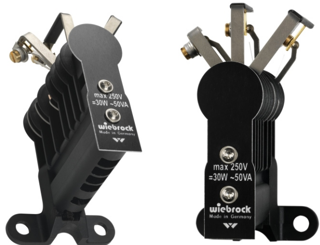
Bild: 3-fach Magnetspringkontakt in Blockausführung einsetzbar z.B. für SF6-Gas Dichtewächter
